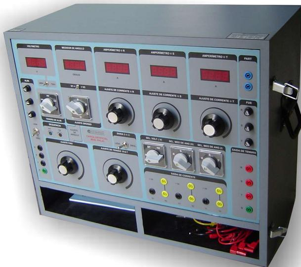
**DESCRIÇÃO GERAL:** É uma unidade, de saída trifásica, com potência de 50 VA, e que possibilita o ajuste do ângulo de fase entre 0,0 a 360,0 graus entre tensões e correntes mono e trifásica, medidos em um fasímetro digital de alta precisão incorporado ao equipamento.
